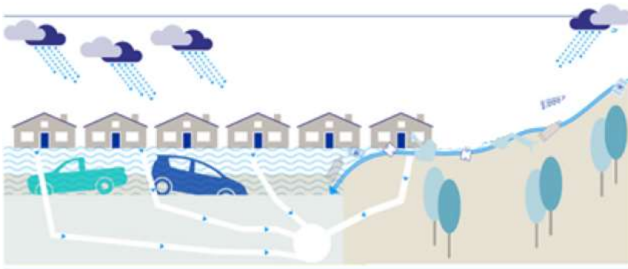
Slika 1.7: Mehanizem nastanka pluvialnih poplav.
